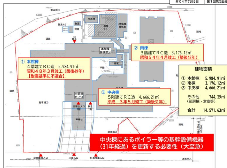
参考資料 6. 公立野辺地病院の建替えの必要性（建物の老朽化 及び 耐震性）
